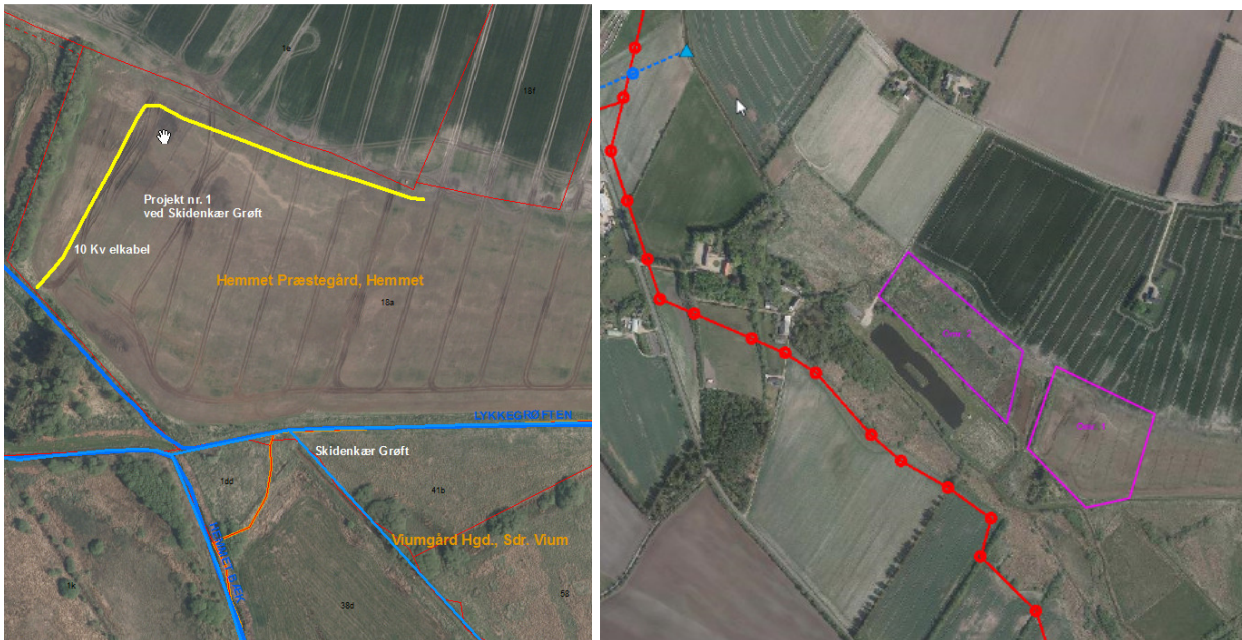
Figur 10. Foreløbige Ledningsoplysninger. Gul linje angiver 10 KV elledning og rød linje angiver hovedspildevandsledning syd for projektområderne
