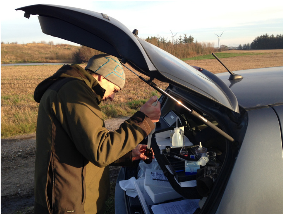
Figur 14. Foto der viser hvordan de udtagende jernprøver fra de okkerbelastede vandløbsstrækninger bliver analyseret.
